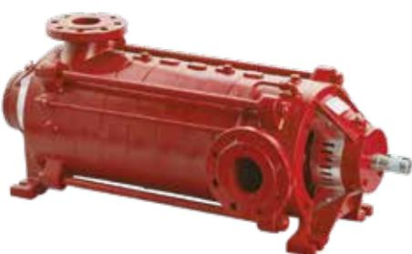
Yatay milli, radyal ayrılabilir gövdeli, çok kademeli, kapalı çarklı, difüzörlü santrifüj pompalarıdır.
